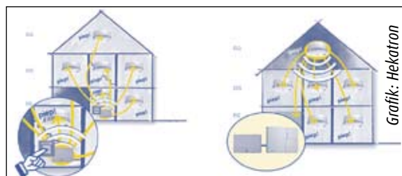
Neue Möglichkeiten mit dem Funk-Interface von Hekatron: Funkvernetzte Rauchmelder dienen auch als Hausalarm- system (l.), Erweiterung der bestehenden Gefahrenmelde- anlage um funkvernetzte Rauchwarnmelder (r.).
