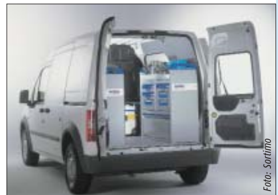
Der Ford Transit Connect mit der neuen Globelyst-Einrichtung, die deutlich weniger Gewicht und eine höhere Anpassungsfähigkeit an die Fahrzeugkontur aufweist.
