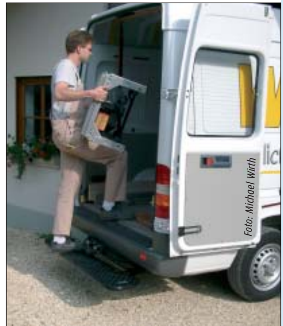
Die herausziehbare Trittstufe Safety Step zeigt am Mercedes Sprinter den bequemen Zutritt. Ein Stapler- oder Hängerbetrieb bleibt möglich.
